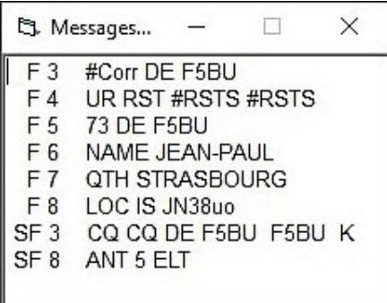
Fig. 6 - Affichage des messages préenregistrés (#Corr et #RSTS sont remplacés par les valeurs présentes dans la barre de contact)
